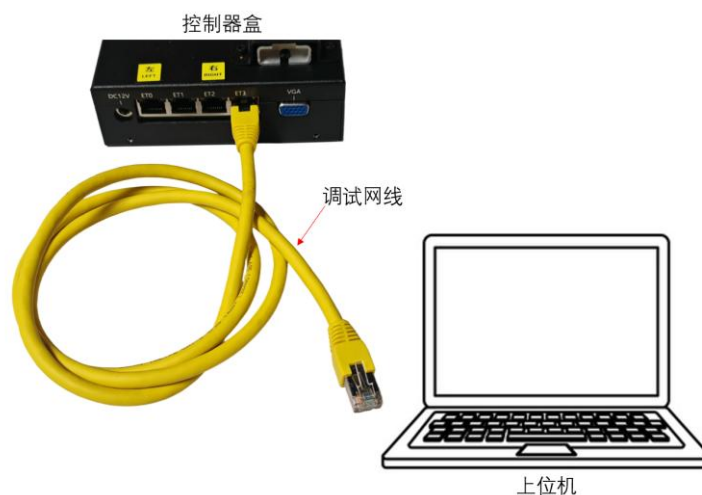
图 3-18 控制器调试网口接线图
