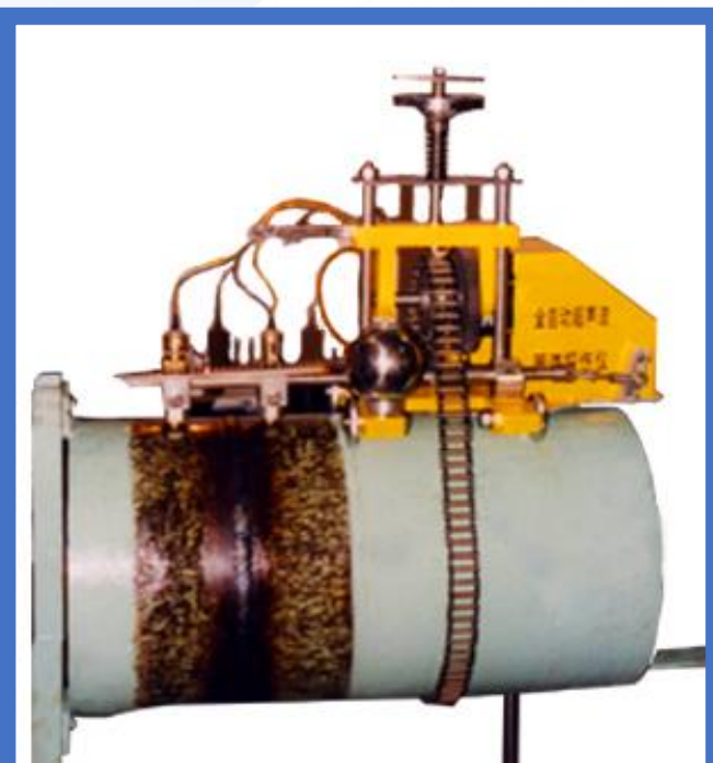
管道环焊缝 超声波检测装置
