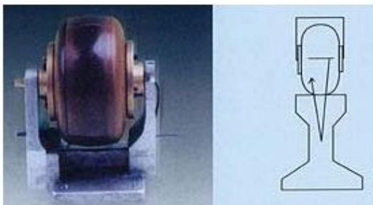
铁路钢轨探测用的滚轴式探头（也称做轮式探头）
