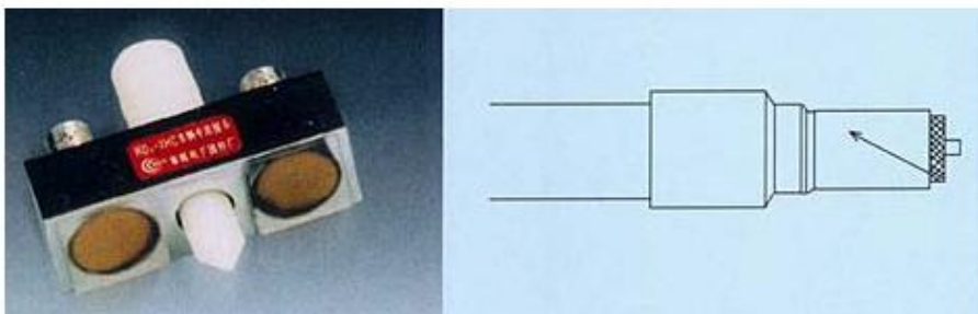
铁路车辆车轴卸荷槽手工探测用探头
