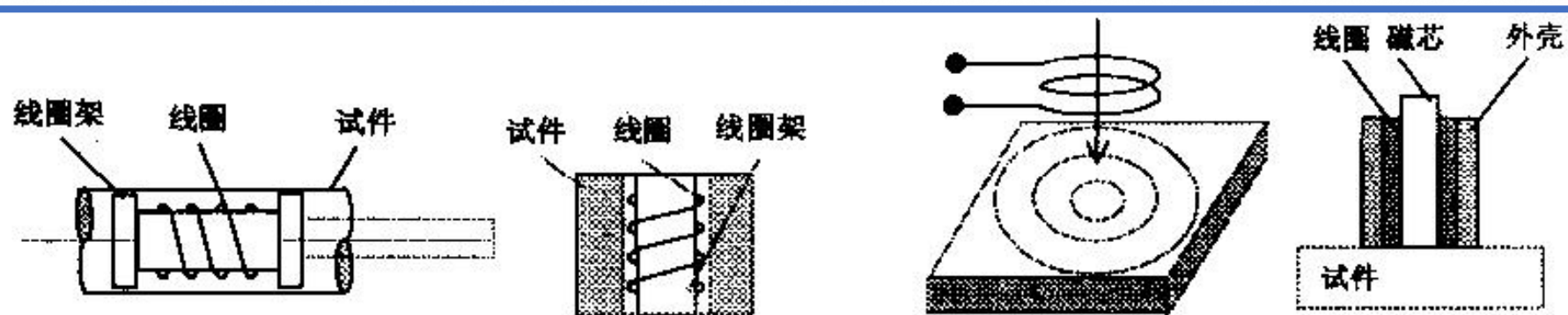
内穿过式线圈结构示意图
