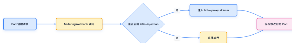
图 12-24: Istio Sidecar 自动注入流程
