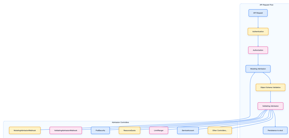
图 11-4: API 请求准入控制流程
