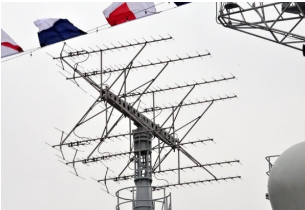
052C 级驱逐舰上的 H/LJQ-517B 雷达；其由 8 个八木天线组成的阵列清晰可见。
