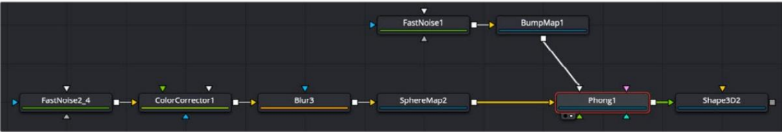
具有漫反射颜色和凹凸贴图输入的 Phong 节点
