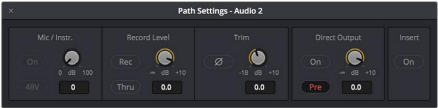
显示音频输入和轨道输入的路径设置窗口
