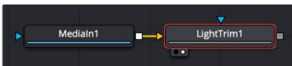
用于调整 LOG 剪辑曝光的 Light Trim 节点
