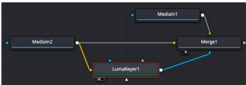
连接到合并节点上的效果蒙版的亮度键控器输出
