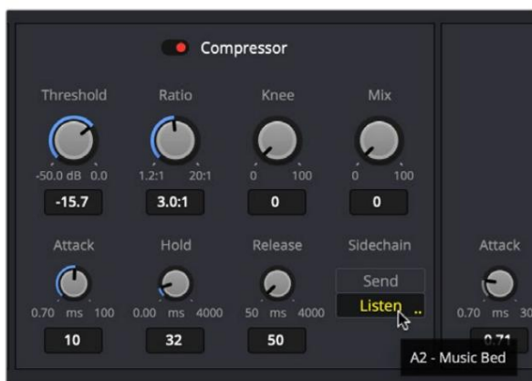
启用侧链监听 分配给音乐曲目的压缩器
