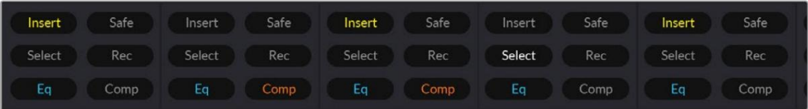
通道 LCD 底部显示串联通道扩展按钮
