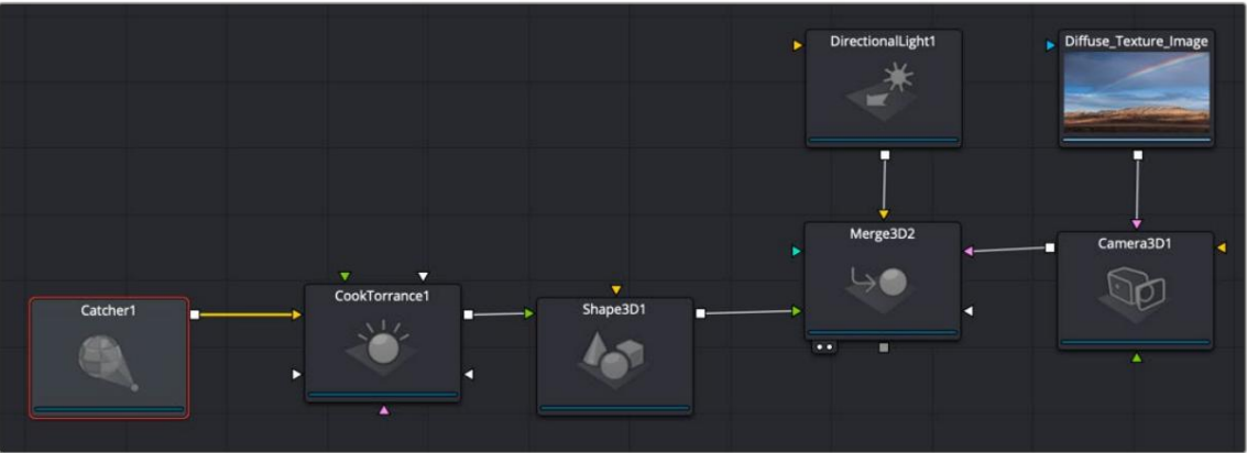
Catcher 节点输出连接到接收纹理投影的几何节点的输入
