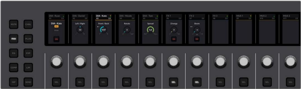
平移控制集映射包括 Fairlight 平移窗口中的所有参数。
