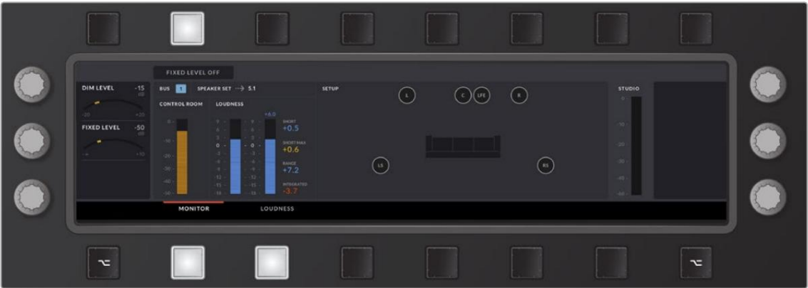
监控模式布局,具有暗淡和固定电平、控制室、响度和录音室仪表的视觉反馈,以及扬声器配置和聆听环境的图形表示。
