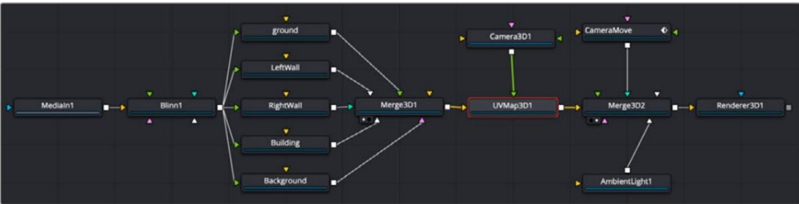
UV Map 3D 放置在 Merge 3D 之后,连接相机以排列纹理
