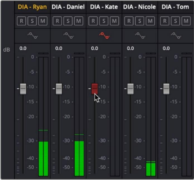
自动化镜像桌面控制台,在 A3 轨道上写入推子自动化数据
