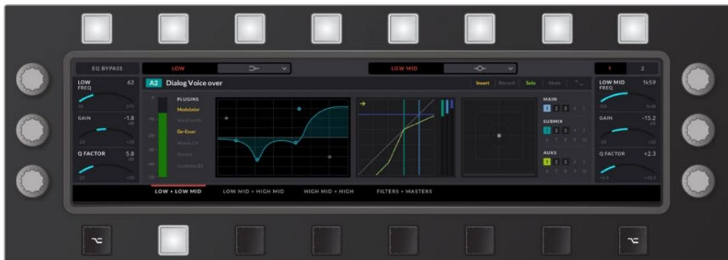
编辑器屏幕显示分配给相邻软按钮和旋钮的 EQ 处理控件
