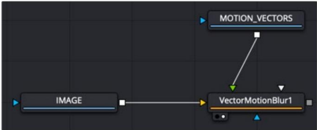
应用于 MediaIn 或 Loader 节点的矢量运动模糊节点,其运动矢量连接到矢量输入
