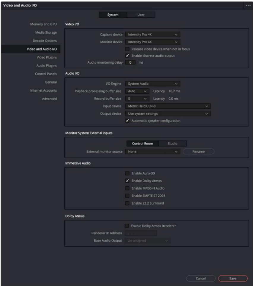
用于在视频和音频 I/O 的首选项面板中启用各种环绕声格式的控件
