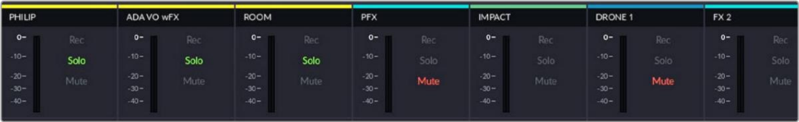
可选 HDMI 监视器显示屏可显示条带模式下通道的轨道状态
