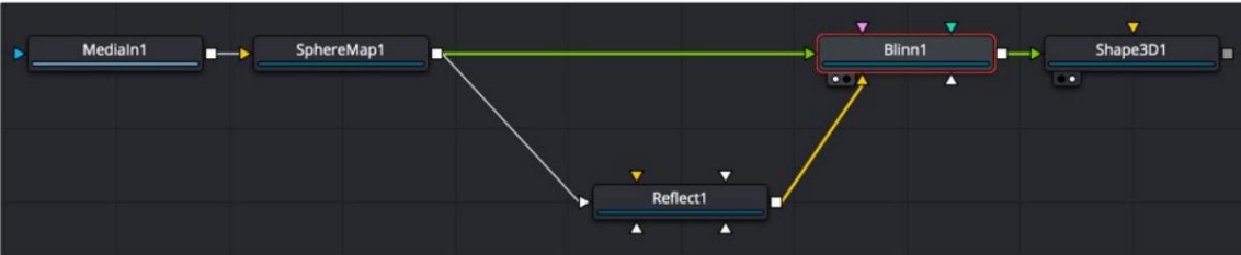
连接了漫反射和镜面颜色材质的 Blinn 着色器
