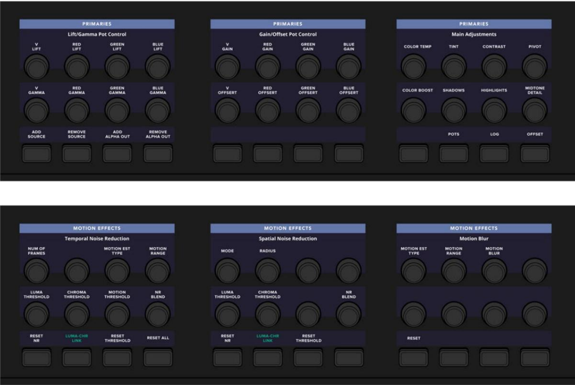
(上)轨迹球面板的软菜单控件对应于原色调色板， (下)与运动效果调色板对应的软菜单控件;注意所有控件如何更新以与当前使用的调色板相关
