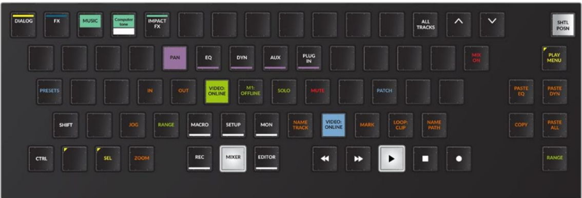
备用混音器工具集,其中“混合打开”未锁定、“复制/粘贴”锁定,并且在滚轮附近提供“复制/粘贴”键
