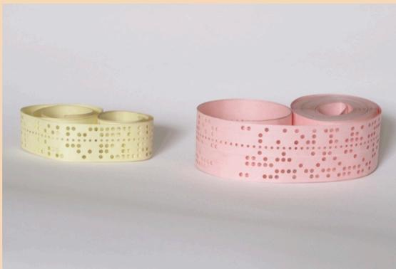
图 4.2: 当初编程用的 5 孔和 8 孔纸带
