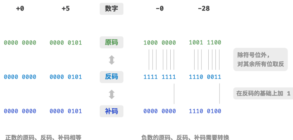
图 3-4 原码、反码与补码之间的相互转换
