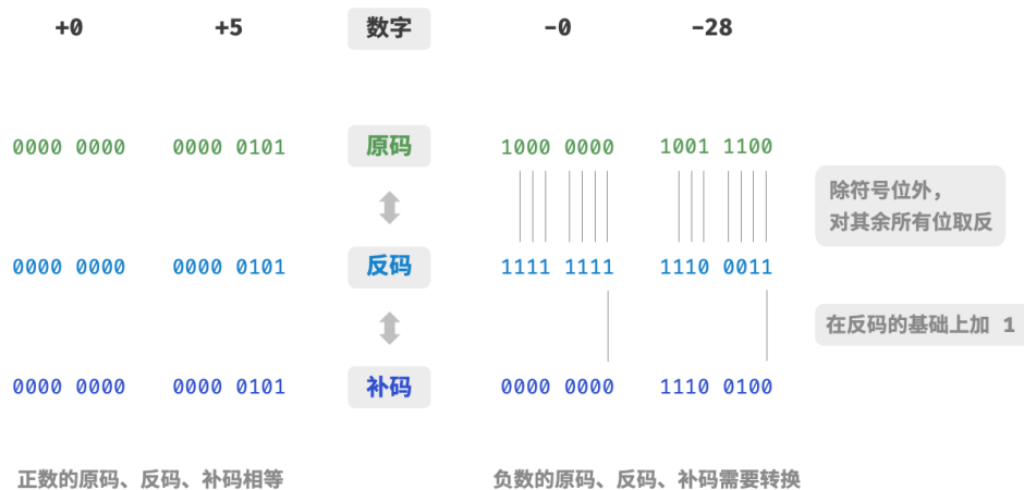
图 3-4 原码、反码与补码之间的相互转换
