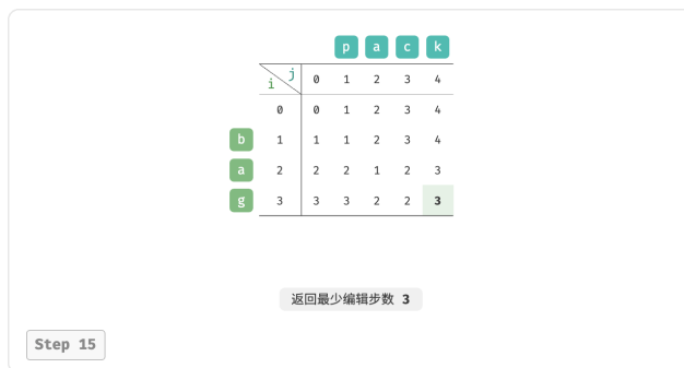
图 14-30 编辑距离的动态规划过程
