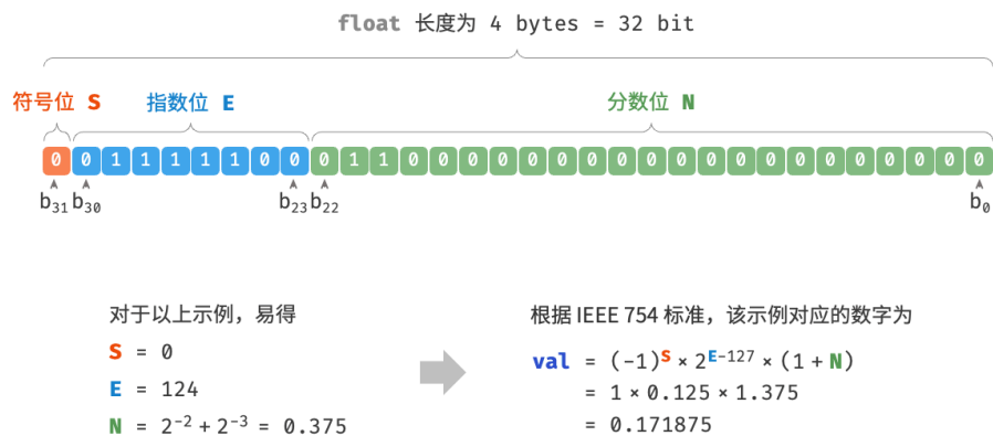
图 3-5 IEEE 754 标准下的 float 的计算示例
