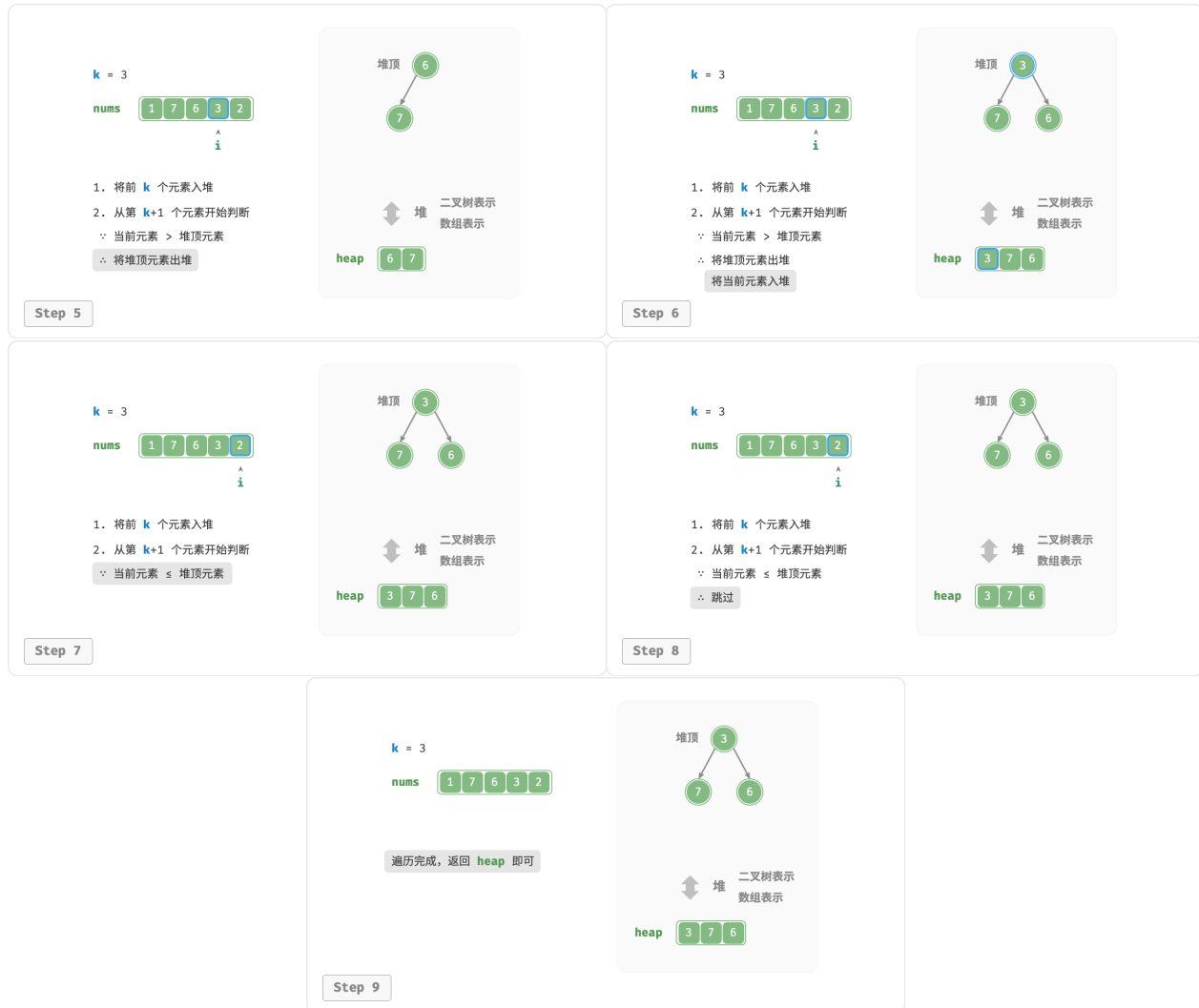
图 8-8 基于堆寻找最大的 k 个元素
